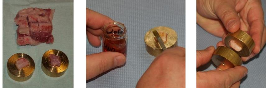
Aufbringen der Gewebeproben auf Träger und anschließende Verklebung für Abreißversuch
